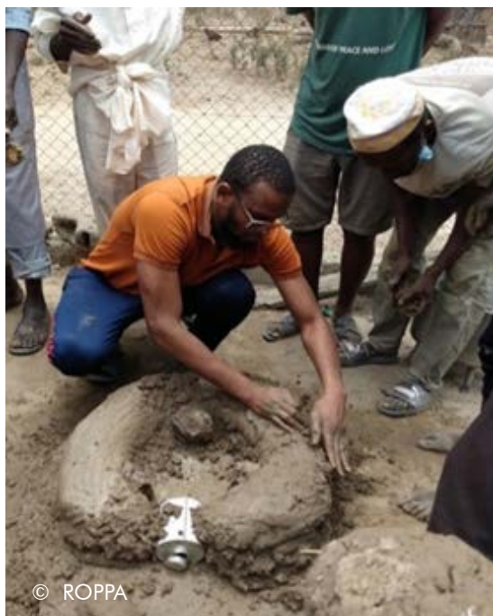
Fabrication de foyer amélioré
