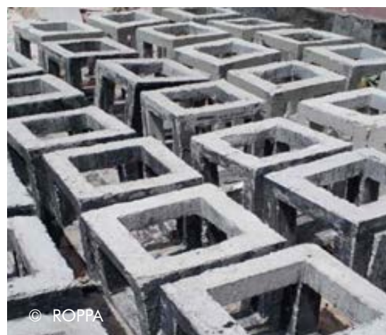
Blocs en béton armé à immerger comme récifs artificiels
